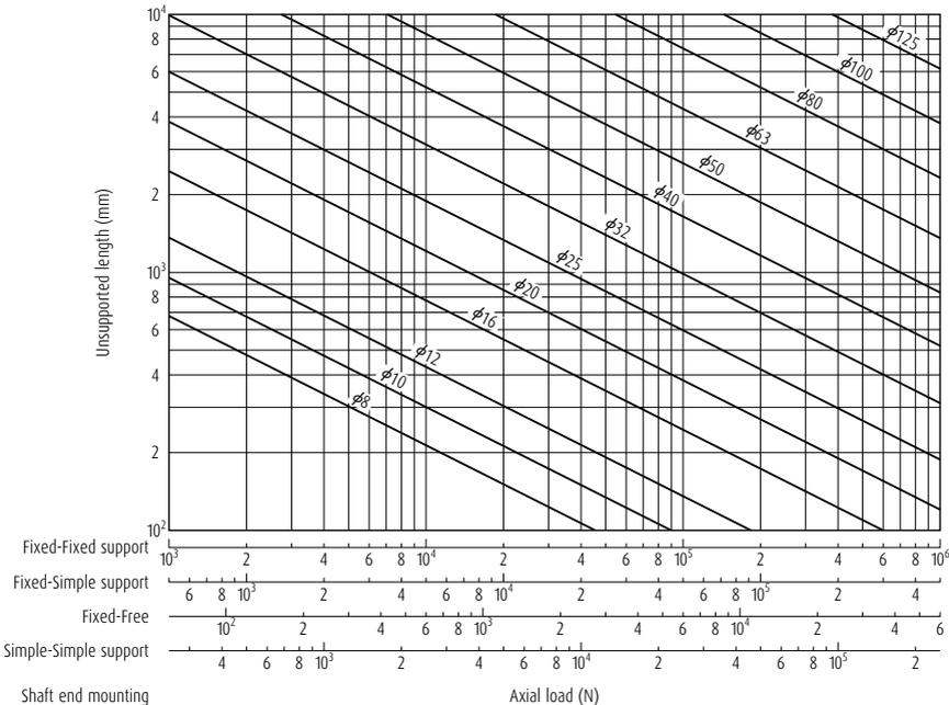
Fig. 2.1 Buckling load
