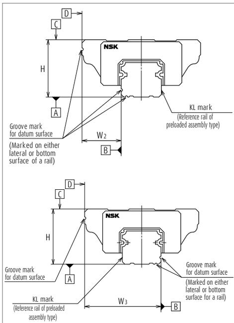
Fig. 4.1 Assembled dimensions
